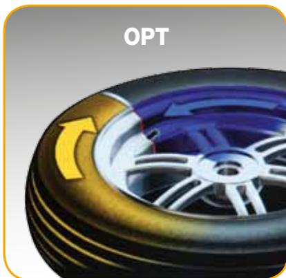
**FR** → Programme indiquant la position de montage idéale entre la jante et le pneu afin de réduire le balourd global de la roue.
