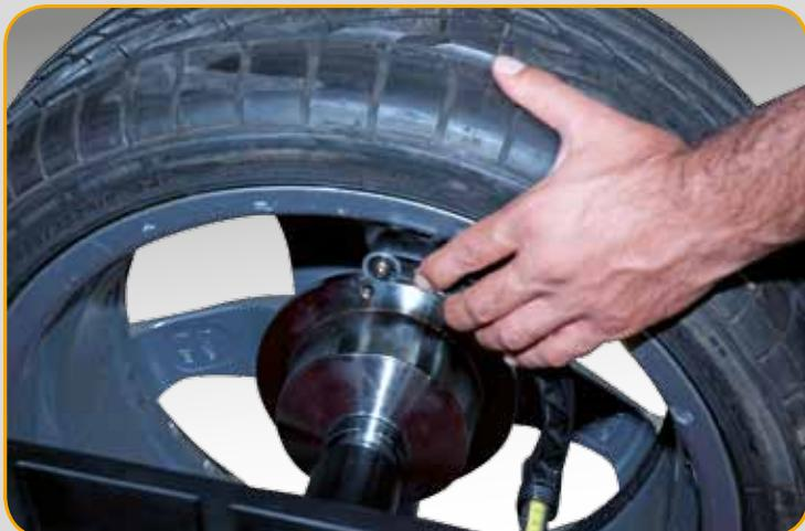
**FR** → Elle dispose aussi d'un détecteur interne qui relève automatiquement la distance et le diamètre jante. Intégrable avec détecteur électronique de la largeur **ES-6**. Disponible aussi dans la version avec détecteur interne manuel.
