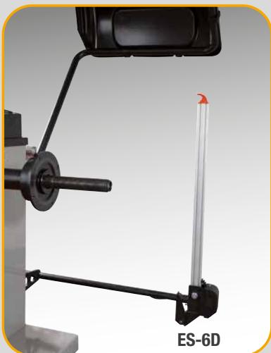
**ES** → **ES-6D Detector externo para la medición del ancho (opcional)**
