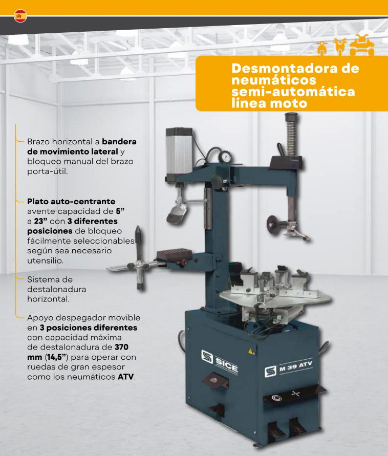
Ideal para un uso profesional e intensivo en neumáticos de moto, scooter, go-kart, maquinaria de jardinería (TURF), e incluso en ruedas de gran espesor como los neumáticos de quad.
