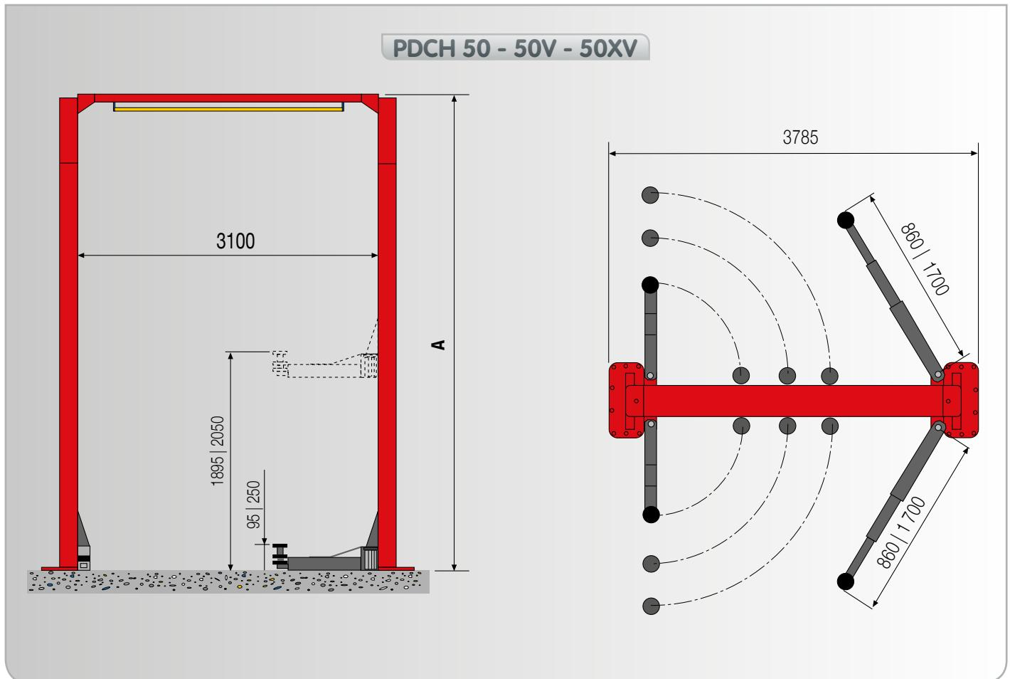
Per i dati tecnici d'installazione ed il fissaggio a terra, fare riferimento alla pagina "Sollevatori" nel sito [www.sice.it](http://www.sice.it)
