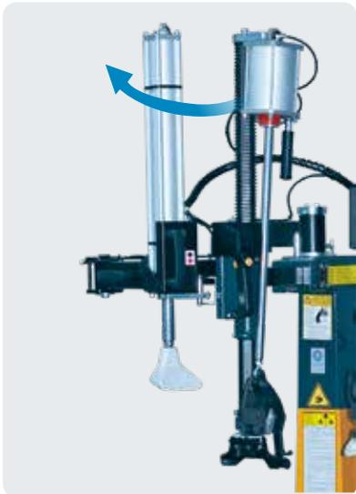
**Pressonador de talão**, de série, **é muito útil com os pneus mais trabalhosos**, durante as fases de desmontagem e montagem. Fica sempre ao alcance das mãos, graças ao sistema de retenção que o fixa ao braço automático de abertura lateral.
