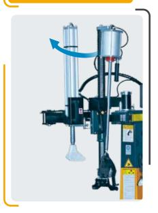
El prensa talón, de serie, es muy útil con los neumáticos más difíciles, durante las fases de desmontaje y montaje. Está siempre al alcance de la mano gracias al sistema de retención que lo conecta con el brazo automático de apertura lateral.
