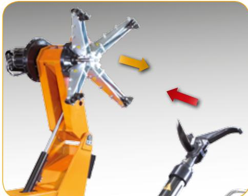
**FR** • Mouvements indépendants entre étau autocentreur et bras porte-outils. Cela vous permettra de positionner, avec la liberté maximale, la roue et les outils à la vitesse la plus élevée possible.
